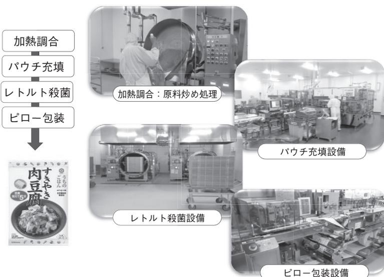
図1 レトルト製品の製造フローの概要
